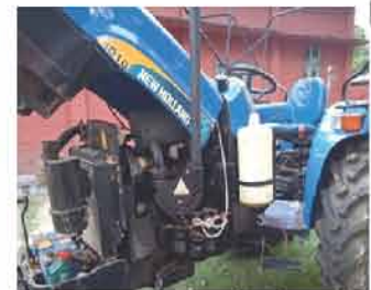
ट्रैक्टर पर लगाया गया ईंधन सेंसर और प्लास्टिक का गौण ईंधन टैंक
