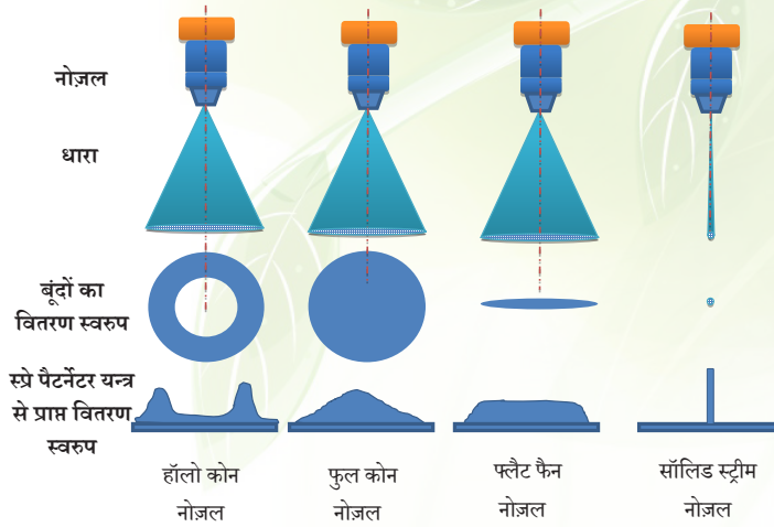
चित्र 7. नोजल के कार्य करने के तरीके का विवरण
